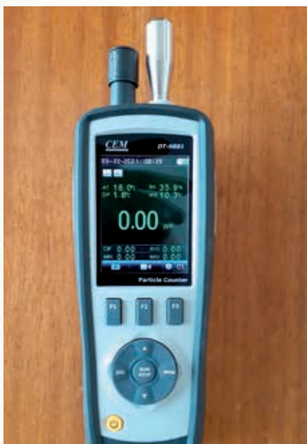
Prístroj CME DT-9881 na meranie formaldehydu, prachových častíc a oxidu uhoľnatého
