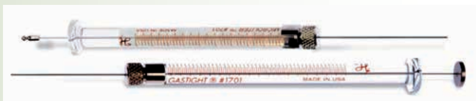
Mikrostriekačka zn. Hamilton, vrchná je vhodná pre autodávkač, spodná pre manuálne dávkovanie
